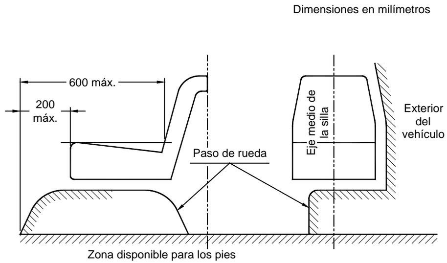
Figura 19. Intrusión permitida de un paso de rueda que sobrepasa el eje medio de una plaza de la silla lateral
