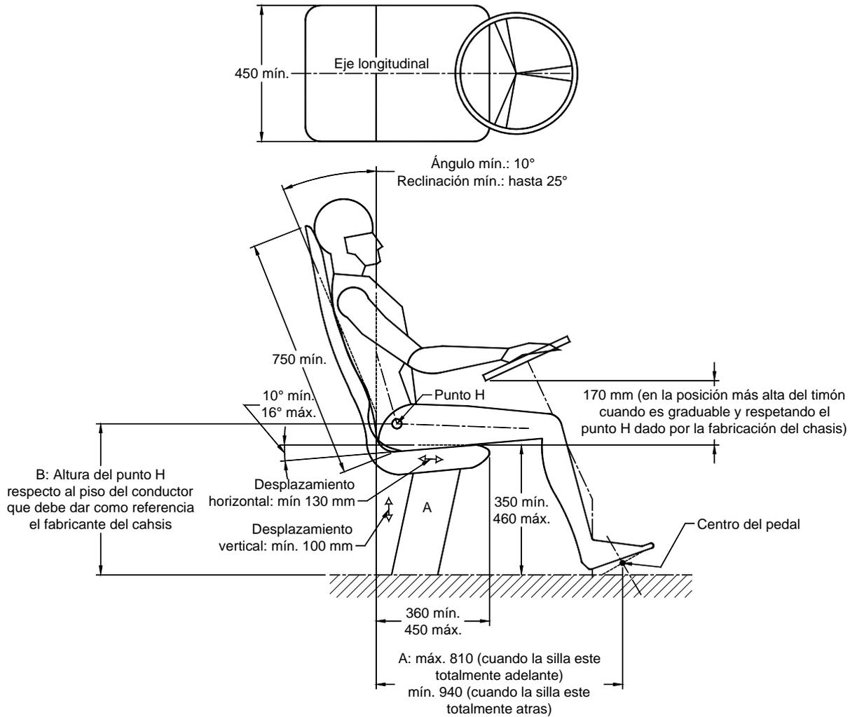
Figura 10. Dimensiones y desplazamientos de la silla del conductor
