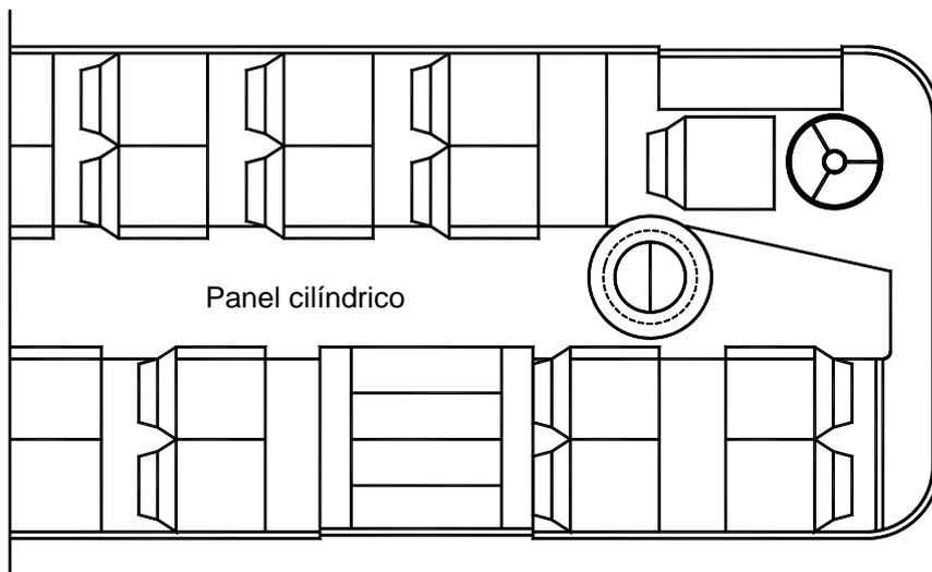
Figura 35. Desplazamiento de la galga por el pasillo del vehículo para sillas orientadas en el sentido opuesto al de la marcha
