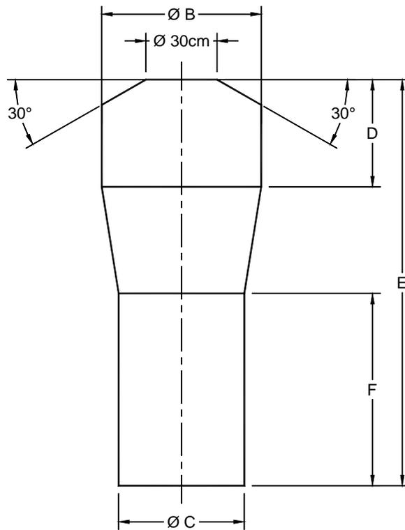
Figura 32. Plantilla cilíndrica para la determinación del espacio del pasillo
