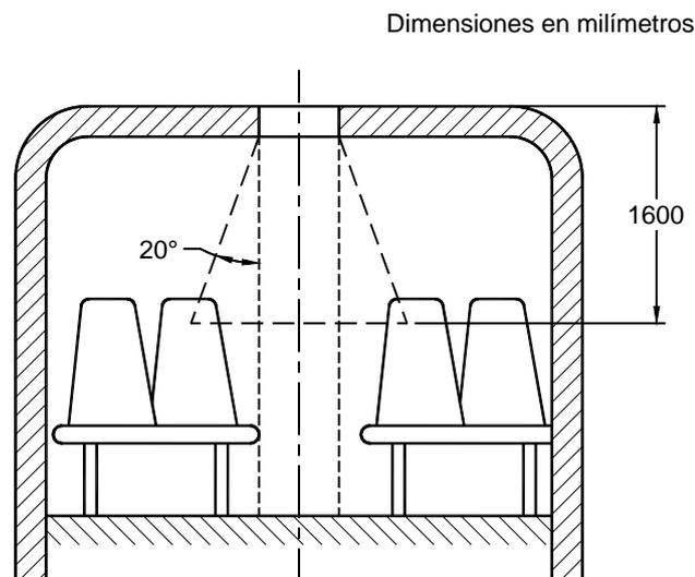
Figura 4. Posición de las escotillas de emergencia
