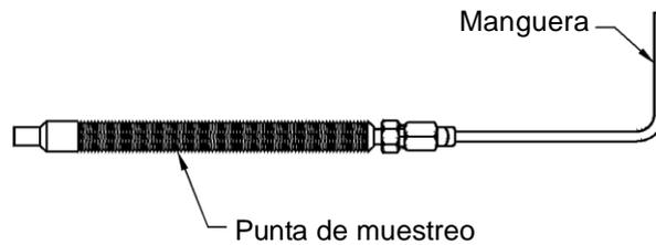
**Figura 1. Ejemplo de sonda de muestreo.**
